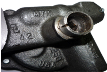
Trabada en su interior
